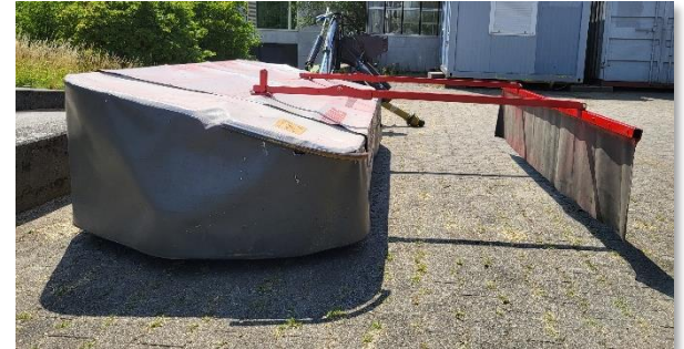
Insektenscheuche: InsectMow Prototyp aus LKW-Plane
