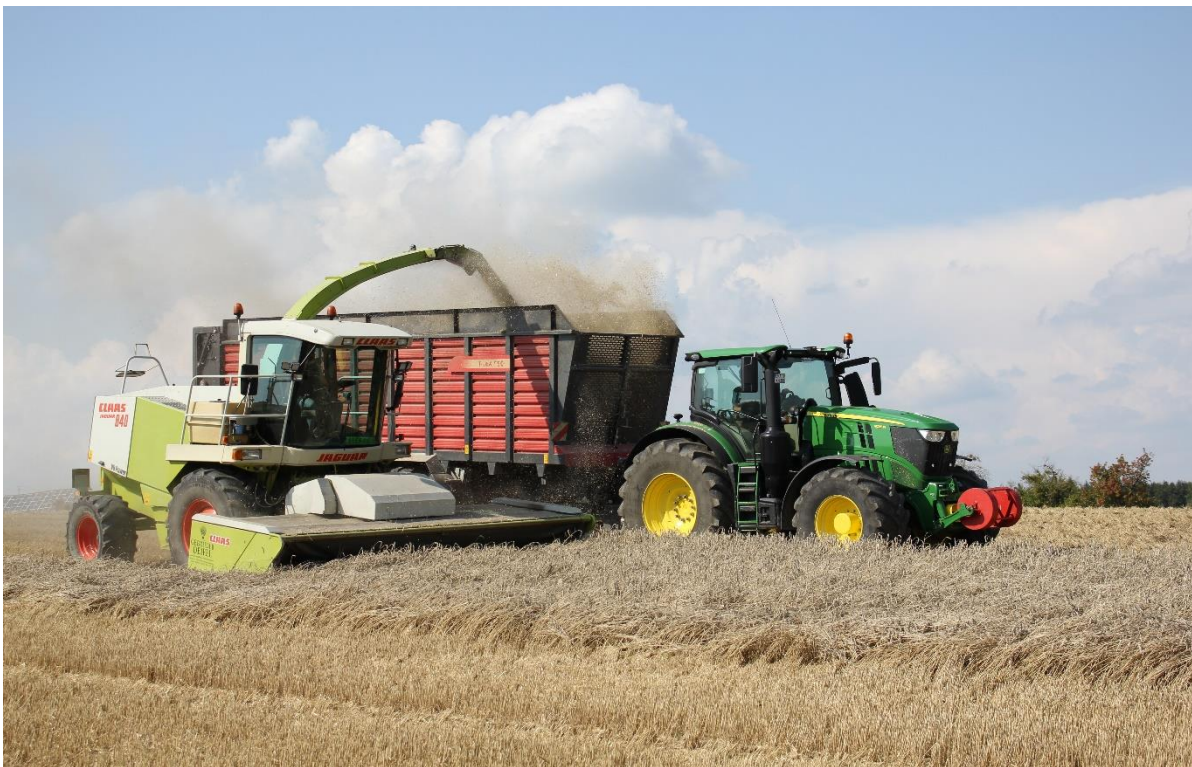
Abbildung 4: Demonstration des Feldhäckseldruschs von Weizen mit moderner Technik – Claas Jaguar 840 mit Direktschneidwerk und großvolumiger Häckselwagen
