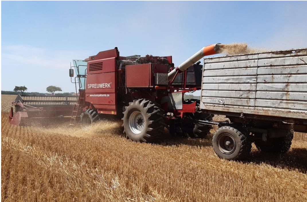
Abbildung 3: Kompakternte-Demonstrationsmaschine auf Basis eines Arcus Mähdreschers für die Korn-Spreu-Stroh-Ernte
