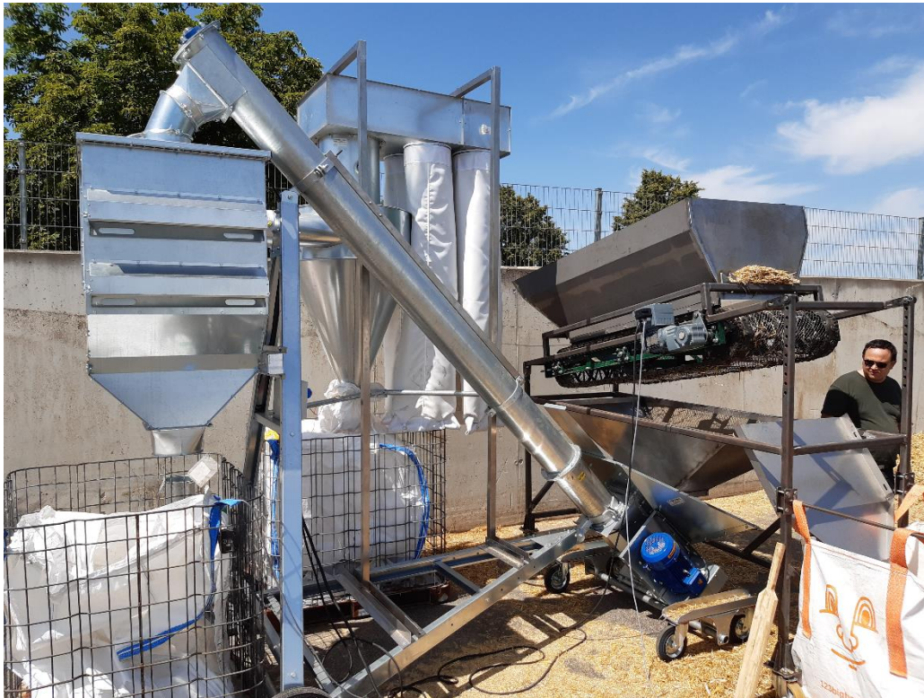
Abbildung 31: Demonstration der Kompakternte-Separationseinheit, bestehend aus Siebband (rechts) und Windsichter
