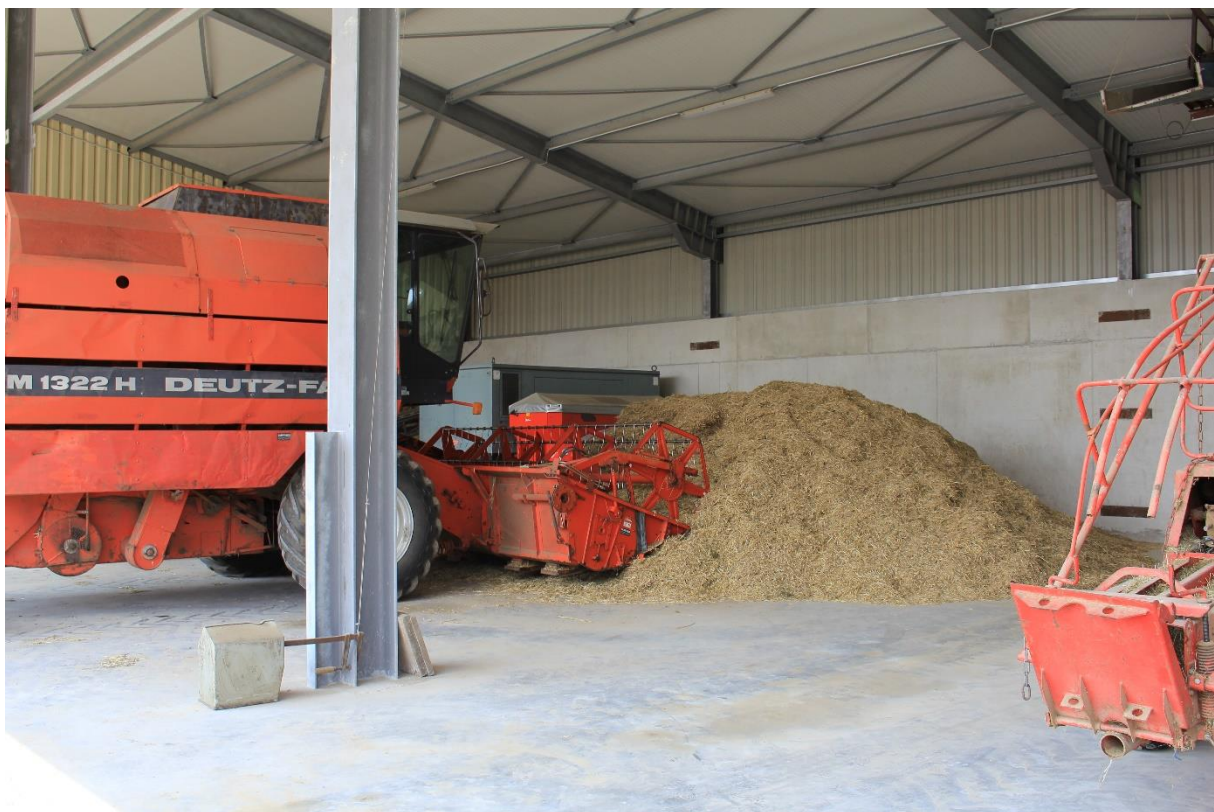
Abbildung 5: Stationäre Trennung von Korn und Biomasse mit dem Mähdrescher zu Versuchszwecken
