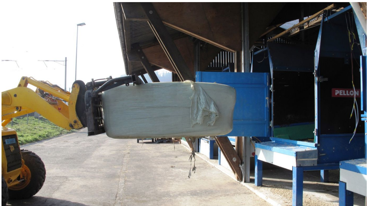
Abb. 11: Befüllung der Quaderballensilage mit der Ballengabel in den Pellon Compact-Vorratsbehälter mit veränderter Befüllklappe
