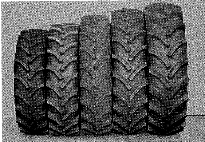
Bild 25: Zur Untersuchung der Reifen- und Betriebsparameter eingesetzte Reifen. Von links: 16.9 R 30, 16.9 R 34, 16.9 R 38, 18.4 R 38, 20.8 R 38.
