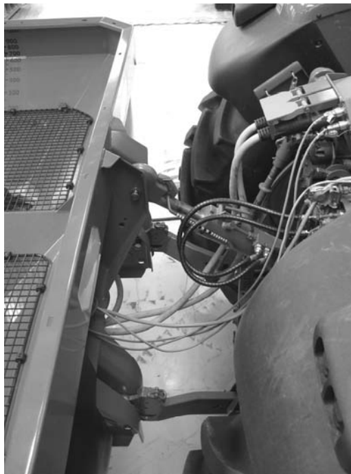
Bild 39: Koppellebene Traktor – Düngerstreuer
