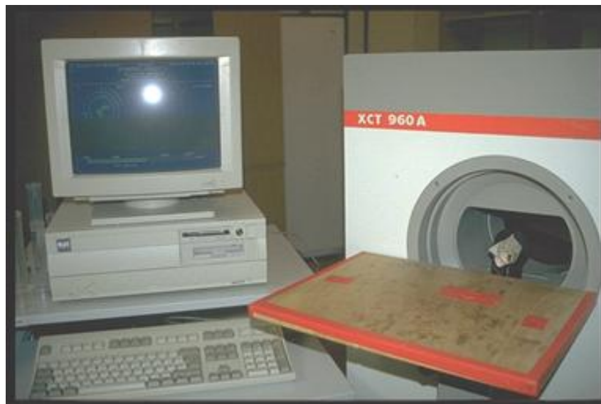
Abb. 13: Computertomograph XCT 960A zur Bestimmung von Knochendichte und -geometrie
