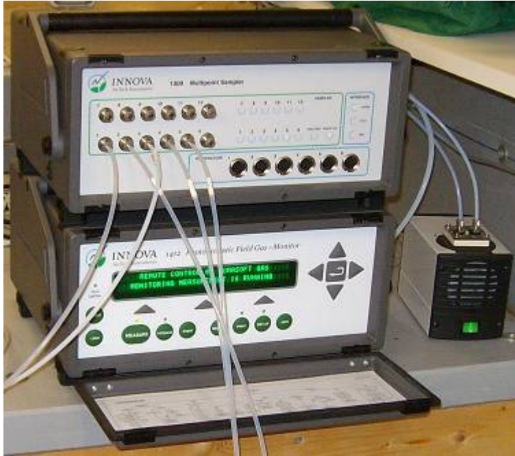
Abbildung 3.7: Multigasmonitor mit Multiplexer und Pumpe
