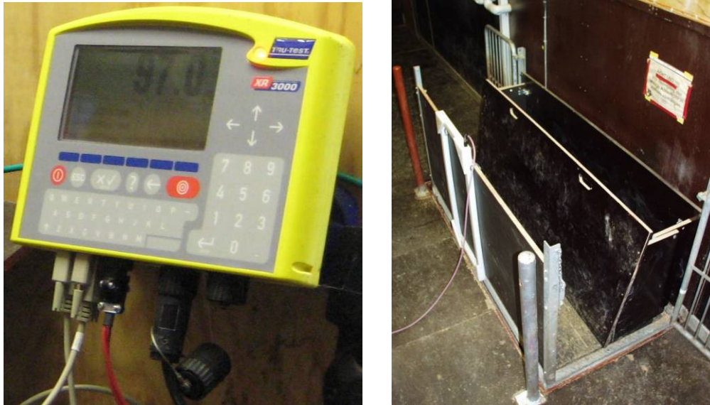
Abbildung 3.6: Waagenterminal (links) und Waage mit RFID Antenne (rechts)
