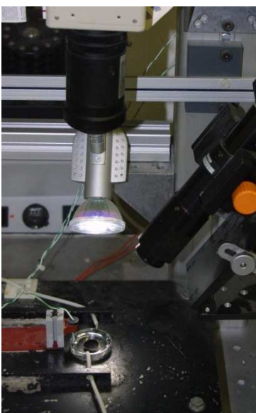
Abbildung 2.4: Nahaufnahme einer Messkammer mit Photomultiplier (rechts).
