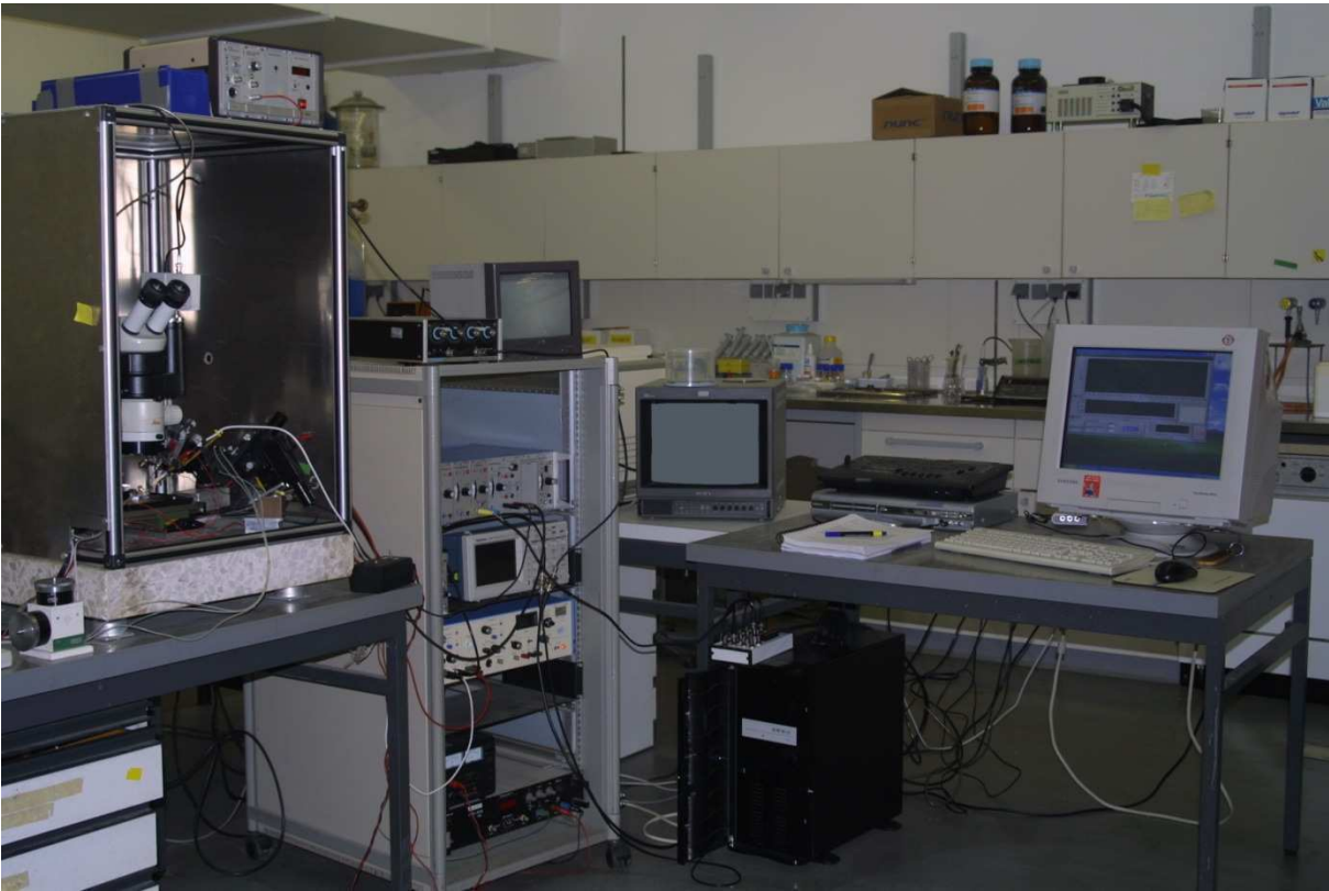
Abbildung 2.7: Photographie des gesamten elektrophysiologischen Messaufbaus (einzelne Bauteile: siehe schematische Darstellung).
