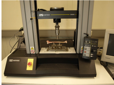
Abbildung 15. Universal-Material-Prüfungsmaschine mit fixiertem Putenknochen
