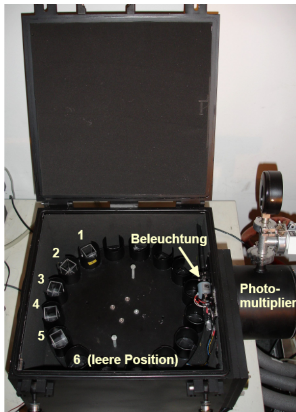
Abbildung 7: Dunkelkammer des PMS-3.1.
