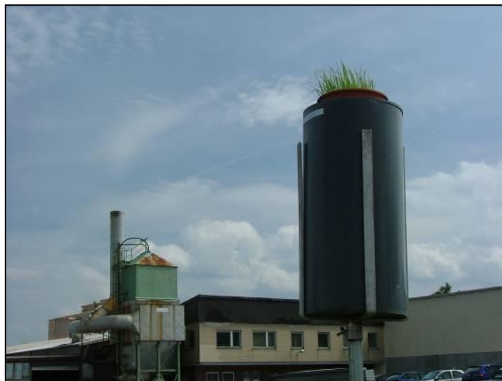
Abb.4.2-1: Pflanztopf im Expositionsgefäß. Im Hintergrund zum Expositionsgefäß ist eine Rauchgasreinigungsanlage (Trockenabsorptionsanlage) eines angrenzenden Emittenten zu sehen.
