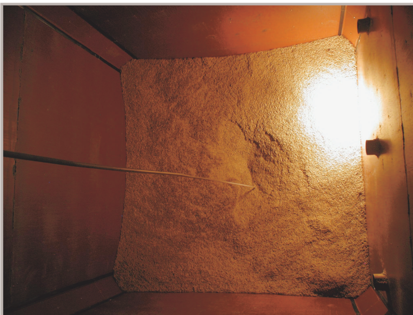
Abbildung 4.1.2 Blick von oben auf Haferpartie 5 während der Entleerung des Silos. Eine deutlich vom umgebenden Bereich abgesetzte Trichterbildung ist zu erkennen.
