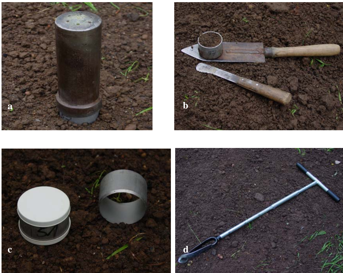
Abb. 10: Eingesetzte Geräte zur Entnahme von Bodenproben in einer Rebschule (a: Stechzylinder mit aufgesetztem Schlageisen zur Entnahme ungestörter Bodenproben; b: Flache Schaufel und Messer zum schonenden Herausnehmen des Stechzylinders aus dem Boden, c: Stechzylinder, links mit aufgesetzten Deckeln; d: Edelman-Bohrer)
