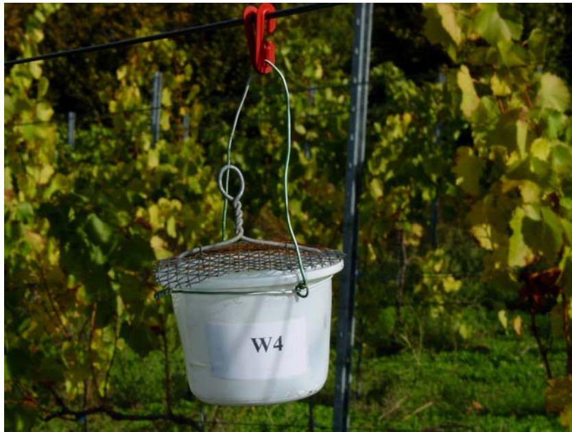
Abb. 7: Fangglas zur Untersuchung von Farbpräferenzen bei Thripsen
