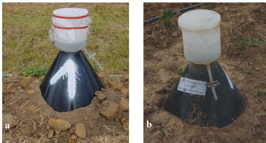
Abb. 4: Boden-Photoelektoren zum Nachweis überwinternder Thripse im Boden (a: Prototyp 2003; b: verbessertes Modell 2004)
