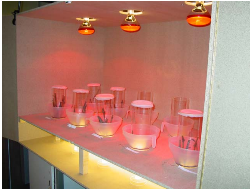
Abb. 9: Berlese-Tullgren-Apparat zum Austreiben von Kleinstarthropoden aus Bodenproben und Pflanzenmaterial
