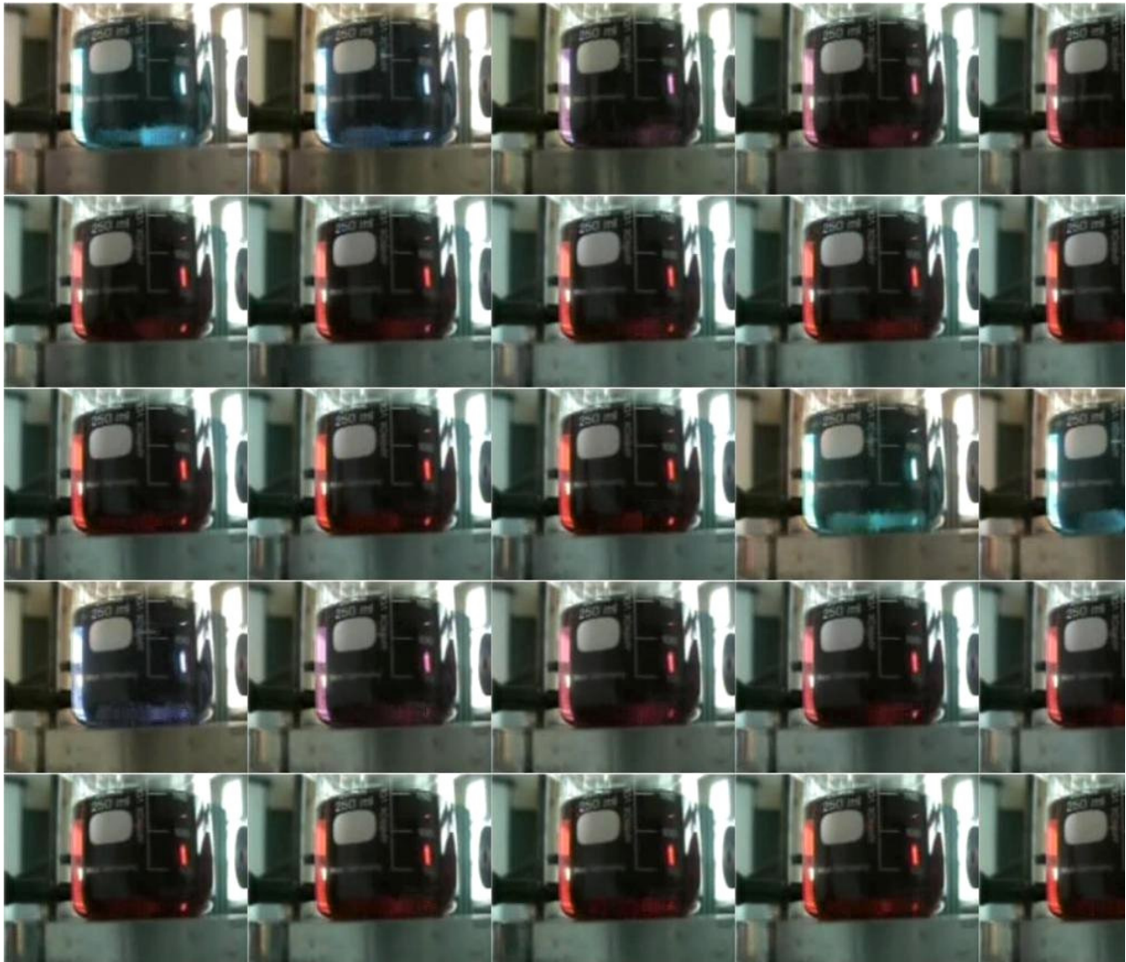
Abbildung 4: Zeitliche Oszillation einer Belousov-Zhabotinsky-Reaktion mit Ferroin als Katalysator (reduziert: rot, oxidiert: blau); Zeitspanne zwischen den Einzelbildern 4 sec.
