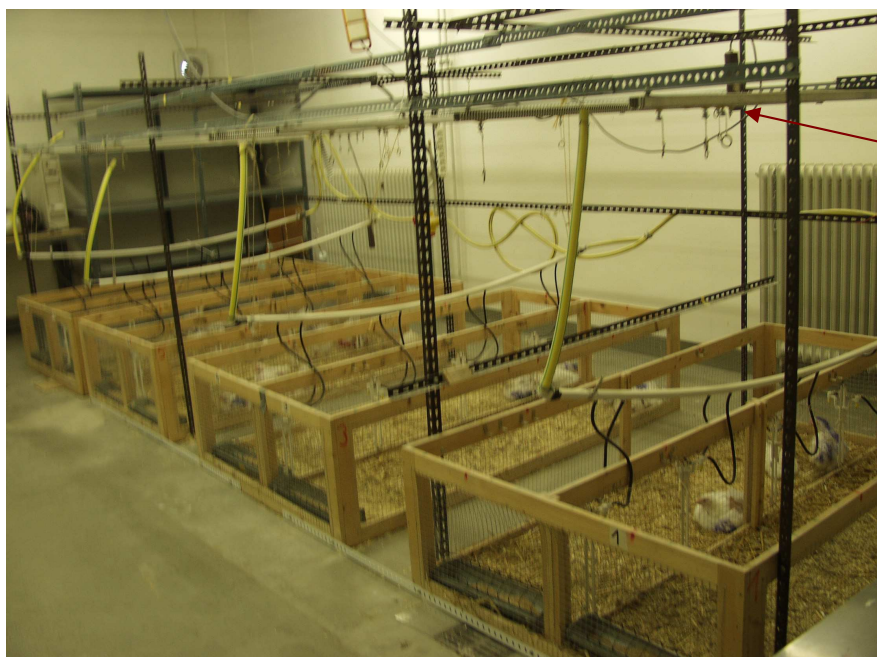
Abbildung 3: Bodenabteile zur Haltung der Tiere mit darüber liegenden Laufschiene für die Entlastung
