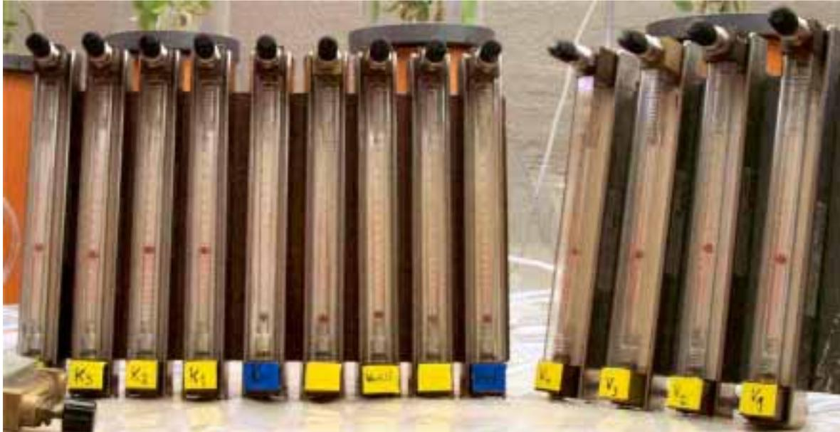
**Abb. 3.1.5: Mechanische Durchflussmesser (Flowmeter) mit Schwebkörper (Fischer & Porter). Oben die Verstellerschraube. Der eingestellte Fluss wird von den Schwebkörpern (Kugel) angezeigt und an der Skala abgelesen.**
