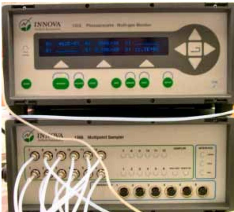
Abb. 3.2.3: Messgerät mit Messstellenumschalter.
