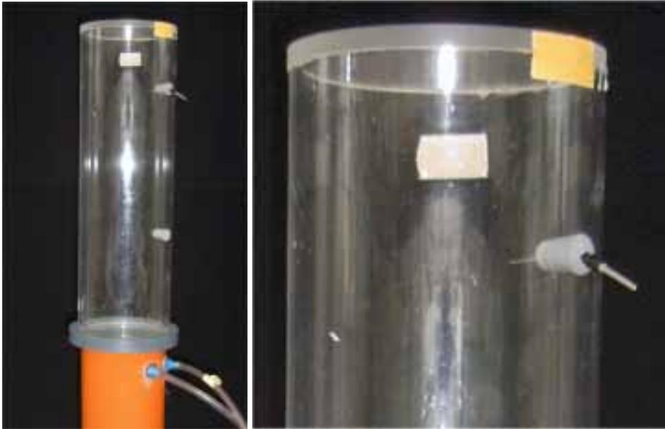
**Abb. 2.2.2.1: Gasdicht verschlossenes Versuchsgefäß mit Acrylglashaube und Doppelkanüle zur Entnahme von Gasproben mit Vakutainern.**
