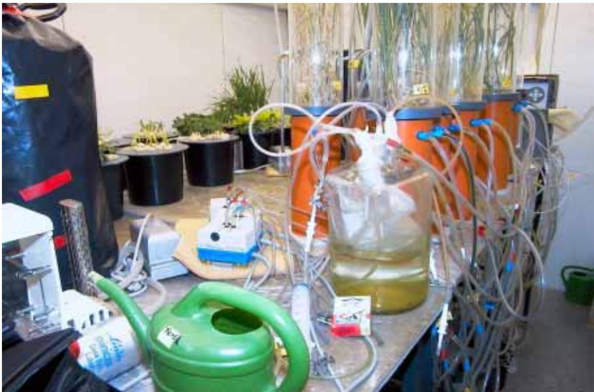
**Abb. 6.3.1: Überblick des Versuchsaufbaus. Auf der linken Seite ist im Vordergrund das für die Lachgasanreicherung verwendete Ausgleichsgefäß zu sehen (Versuchspflanze Gerste).**
