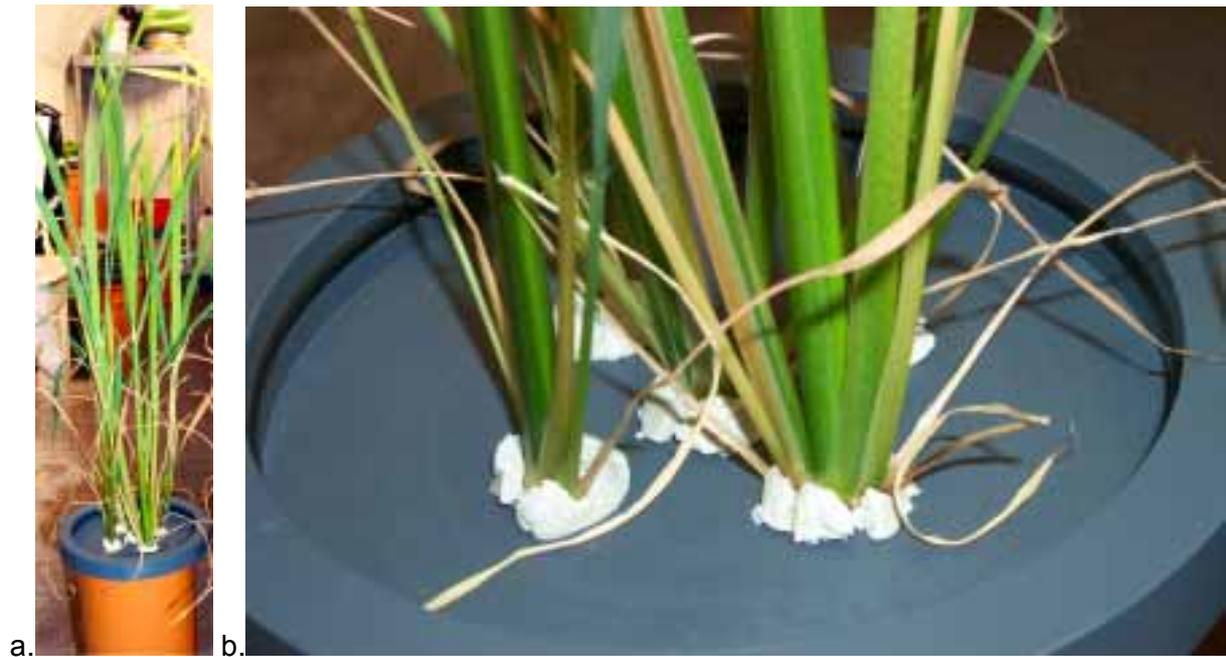
**Abb. 8.3.1: Versuchsgefäß mit Reispflanzen (a.). Vergrößerte Aufnahme der Abdichtung der Reispflanzen mit Silikonkautschuk (Fa. Thauer, Dresden) (b.).**
